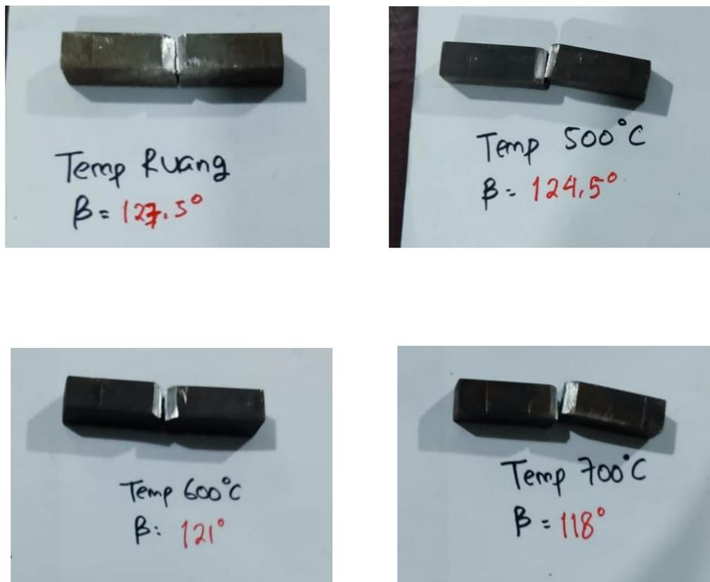
**Gambar 4. 1** Hasil pengujian impak dengan perbedaan temperatur
