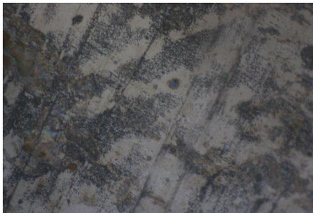
**Gambar 4. 6** Hasil uji struktur mikro temperatur 600 °C
