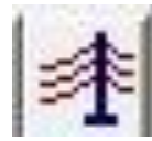
Gambar 2.13 Simbol transmission line pada ETAP
