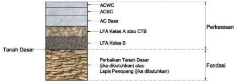
Gambar 2.1 Struktur perkerasan lentur pada tanah asli
