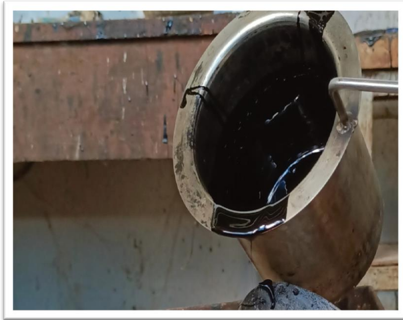
Gambar 1. Benda uji dipanaskan kemudian dikemudian dimasukkan didalam cawan \pm 25^{\circ}\text{C}
