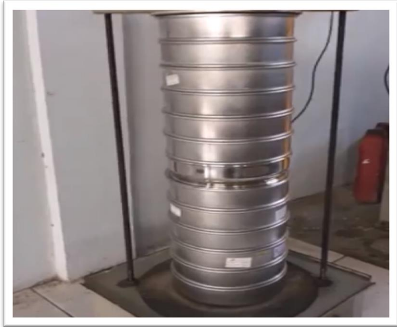
Gambar 3. Masukkan benda uji dari ayakan paling atas lalu pasang satu set ayakan yang sudah di isi benda uji pada mesin penggetar. Nyalakan mesin selama 10 menit
