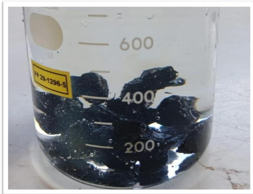
Gambar 6. Memasukan campuran agregat kasar dengan aspal pada wadah gelas yang berisi air suling kemudian dibiarkan selama 16-18 jam
