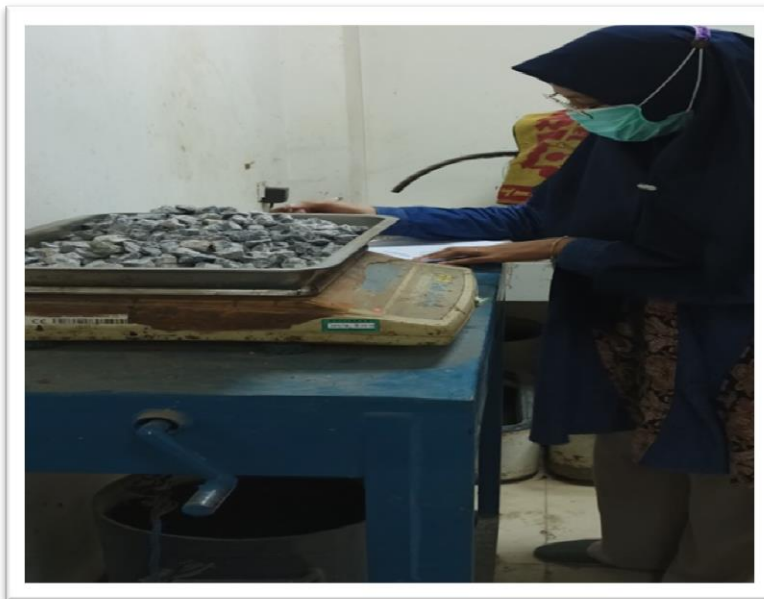
Gambar 6. Setelah di oven 24 jam agregat dalam suhu ruang kemudian di timbang berat benda uji kering oven lalu lakukan perhitungan (Sumber: Dokumentasi laboratorium)
