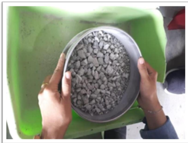
Gambar 2. Merendam agregat yang sudah dibersihkan ke dalam bak perendam selama 24 jam (Sumber: Dokumentasi laboratorium)
