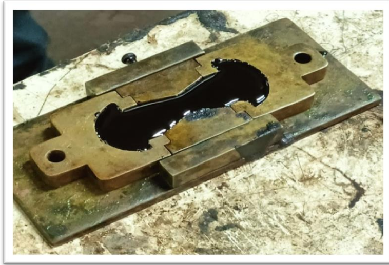
Gambar 3. Masukkan aspal ke dalam cetakan dan diamkan hingga mengeras selama \pm 45 menit didalam ember yang berisi air dengan suhu 25^{\circ}\text{C}
