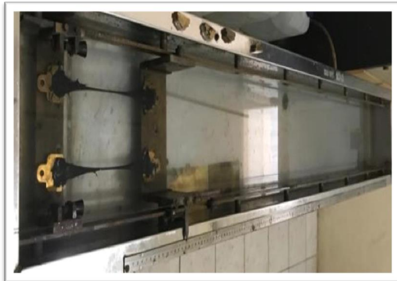
Gambar 4. Mesin uji diisi air yang dicampurkan dengan gliserin sebanyak 20 L, setelah aspal mengeras lepaskan alas cetakan pada sampel dan pasang cetakan pada mesin uji.
