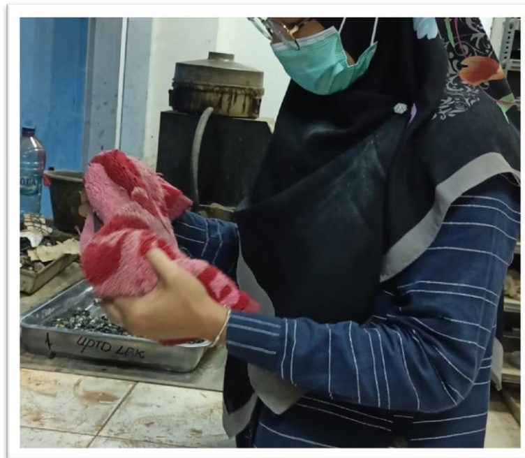
Gambar 4. Lap agregat menggunakan handuk lalu timbang agregat untuk mendapatkan berat SSD (Sumber: Dokumentasi laboratorium)
