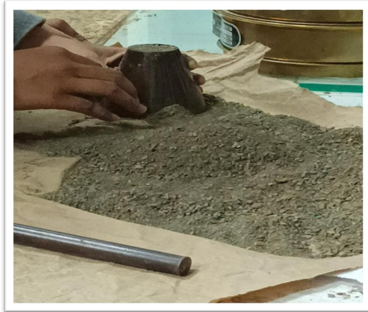
Gambar 3. Mengisikan benda uji kedalam kerucut terpancung, padatkan dengan batang penumbuk selama 25 kali. Keadaan kering permukaan jenuh tercapai bila benda uji \frac{1}{3} dari tinggi agregat maka disitu di dapat tinggi agregat SSD.
