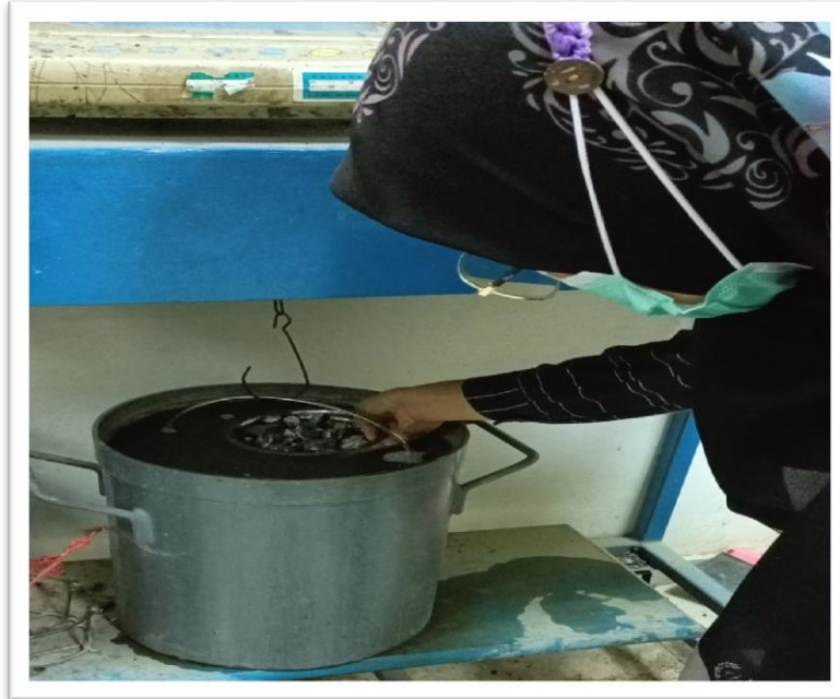
Gambar 3. Rendam agregat untuk mendapatkan berat benda uji didalam air (Sumber: Dokumentasi laboratorium)
