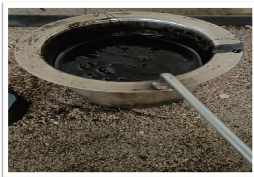
Gambar 2. Memanaskan aspal yang akan dicampurkan dengan agregat kasar dengan suhu 150°C
