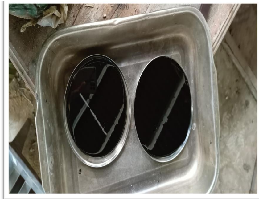
Gambar 3. Tuangkan aspal ke dalam cawan sebanyak 50 gram dan siapkan benda uji ganda
