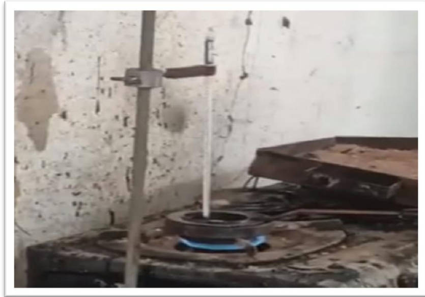
Gambar 1. Isi cawan dengan benda uji dan tempatkan diatas pelat pemanas dan Catat hasil pengujian titik nyala yang diperoleh dari pembacaan termometer pada saat benda uji mulai nyala.
