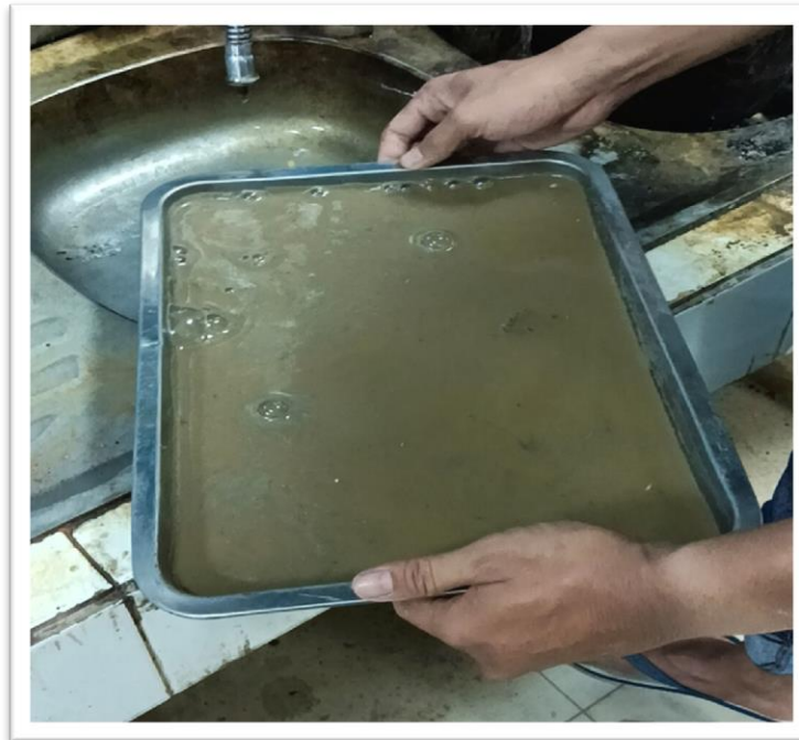
Gambar 1. Agregat halus dimasukkan ke wadah perendam selama 24 jam, agar mendapatkan penyerapan air yang sempurna ke dalam agregat
