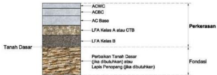
Gambar 2.3 Struktur perkerasan lentur pada galian
