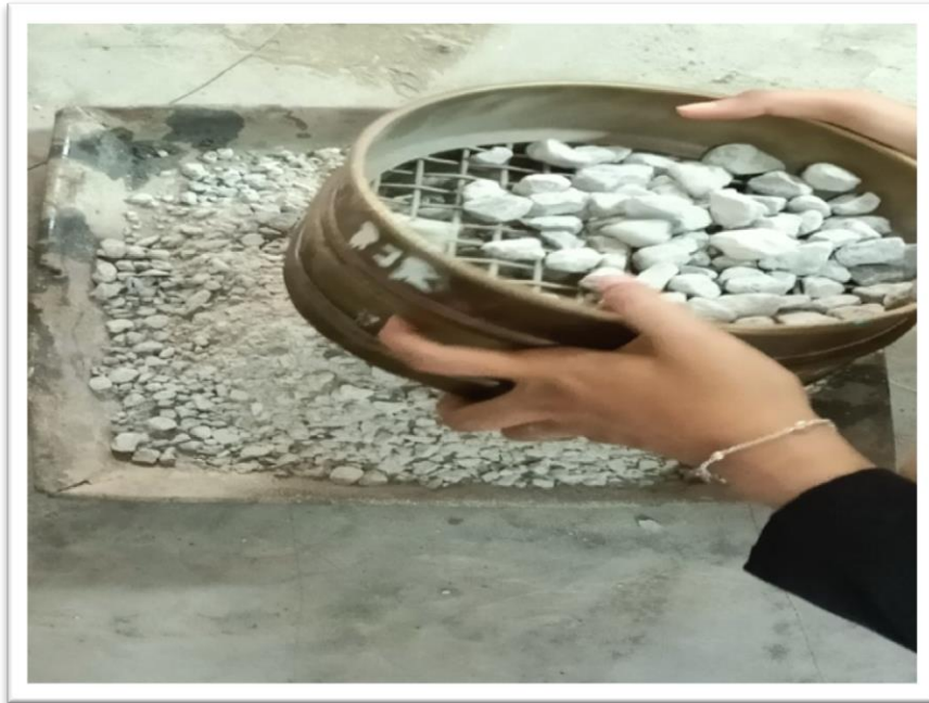
Gambar 3. Setelah diputar dengan mesin los angeles saring agregat dengan saringan no.12 kemudian timbang yang tertahan saringan no.12
