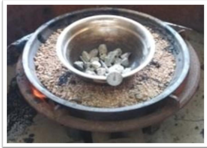
Gambar 3. Memanaskan agregat kasar dengan hingga suhu 150°C yang akan dicampur dengan aspal
