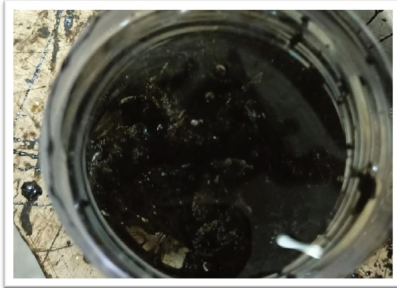
Gambar 7. Memperhatikan campuran dalam wadah apakah terjadi pengelupasan aspal
