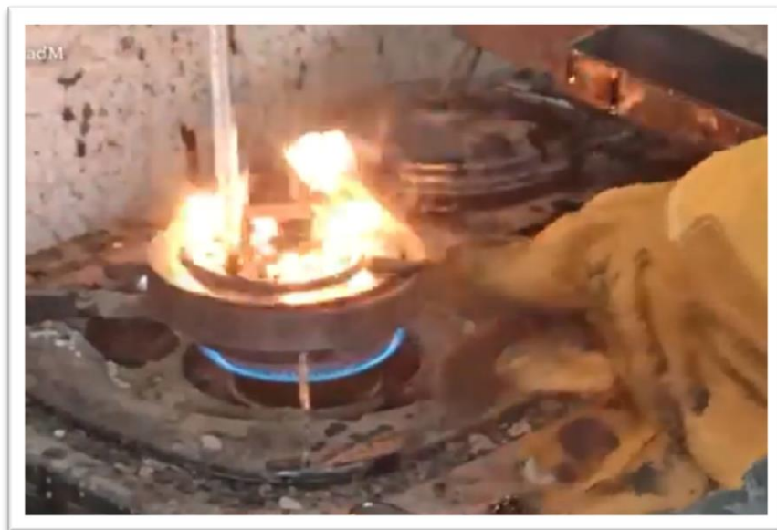
Gambar 2. Perhatikan besarnya nyala api, kecepatan kenaikan temperatur dan kecepatan gerakan api diatas benda uji. Sampai benda uji menyala dan terbakar minimal 5 detik, catat temperatur sebagai titik bakar.
