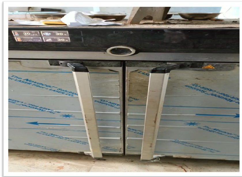
Gambar 4. Mencampurkan agregat kasar dengan aspal sebanyak 6 gram dan masukan dalam oven selama 2 jam pada temperature 60 °C
