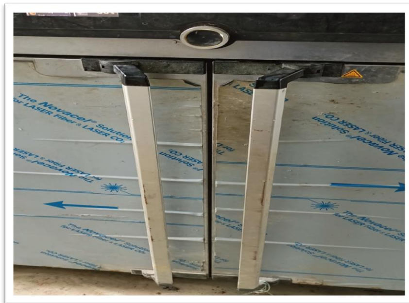
Gambar 2. Masukkan benda uji ke dalam oven selama 24 jam dengan suhu 110°C
