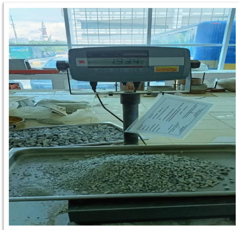
Gambar 4. Setelah mesin berhenti, keluarkan agregat dan timbang berat tertahan pada masing-masing ayakan. Lakukan hal yang sama pada uji agregat halus.
