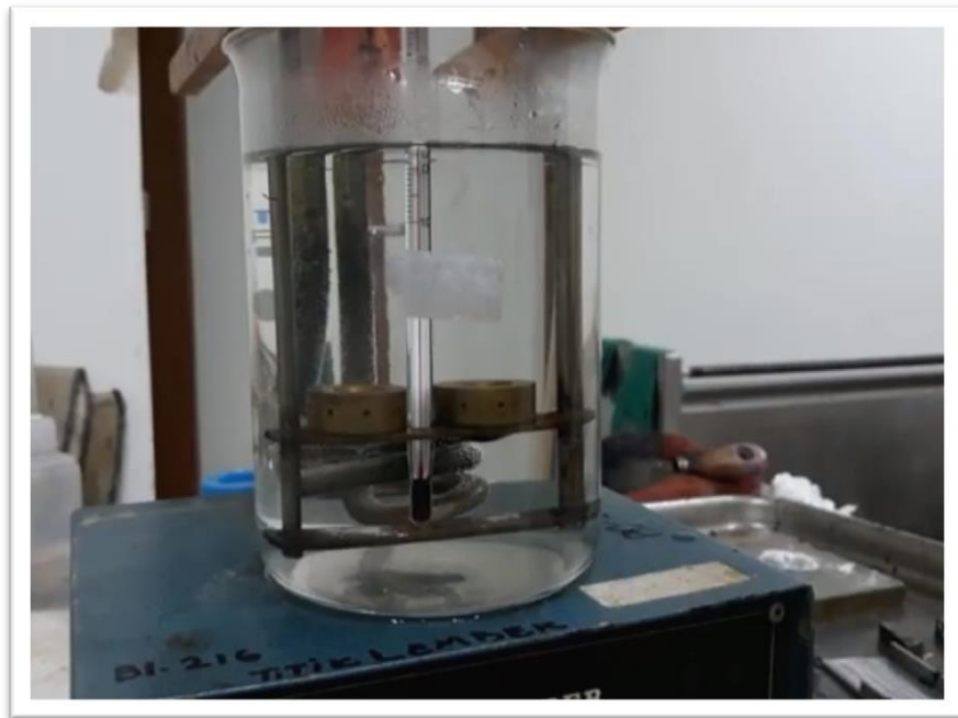
Gambar 3. Benda uji dipanaskan hingga bola besi jatuh kebawah
