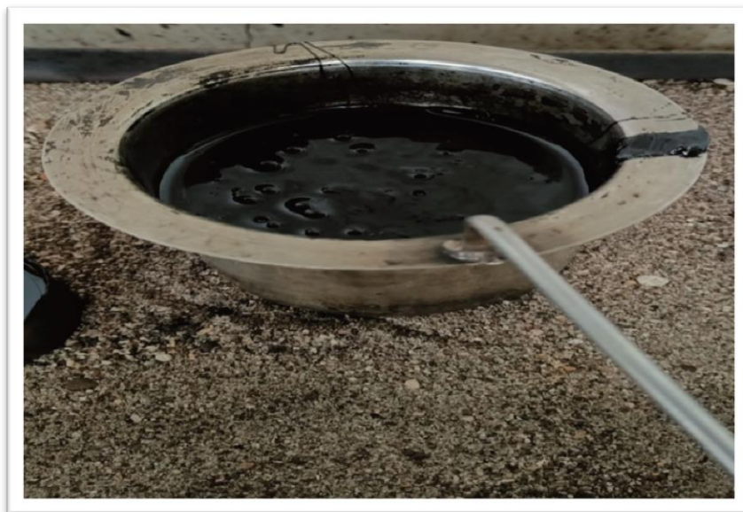
Gambar 1. Panaskan aspal hingga mencair serta lapisilah bagian atas dan bawah cetakan serta permukaan bagian pelat cetakan dengan oli. Kemudian susun cetakan tersebut (Sumber: Dokumentasi laboratorium)
