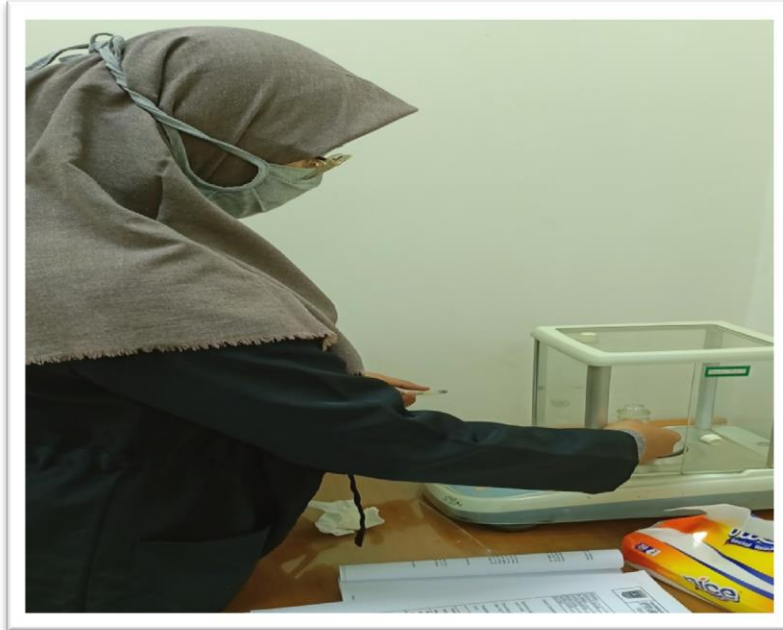
Gambar 2. Timbang berat air (aquades) yang berada dalam piknometer (Sumber: Dokumentasi laboratorium)
