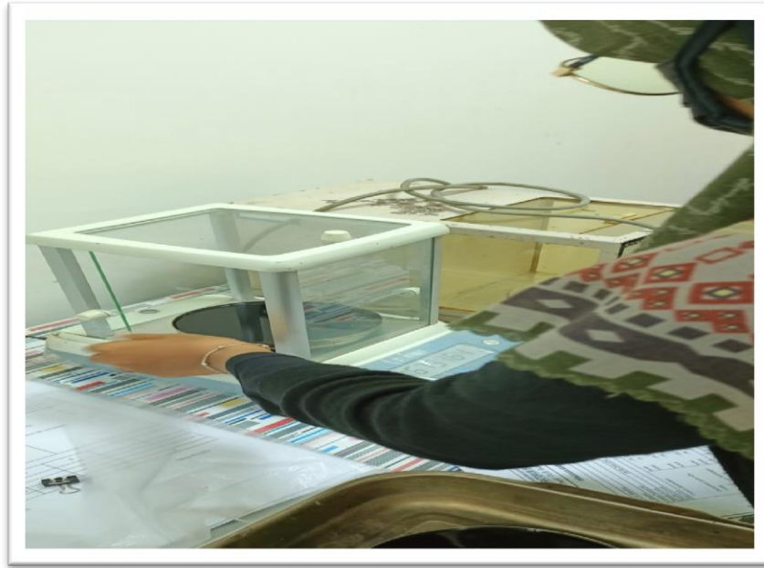
Gambar 5. Dinginkan benda uji pada suhu ruang, kemudian di timbang lalu lakukan pengolahan data
