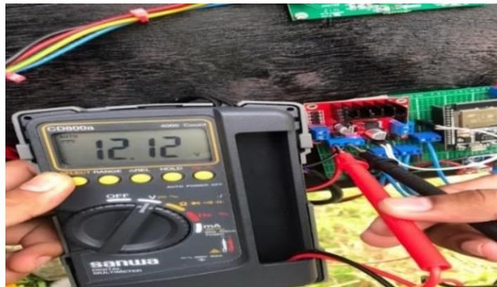
Gambar 4.3 Pengujian Motor Driver
