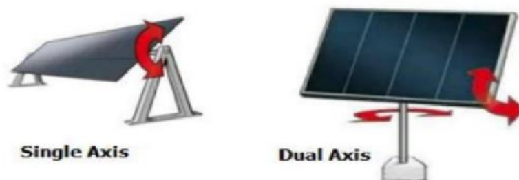
Gambar 2.1 Jenis solar tracker berdasarkan sumbu putar.
