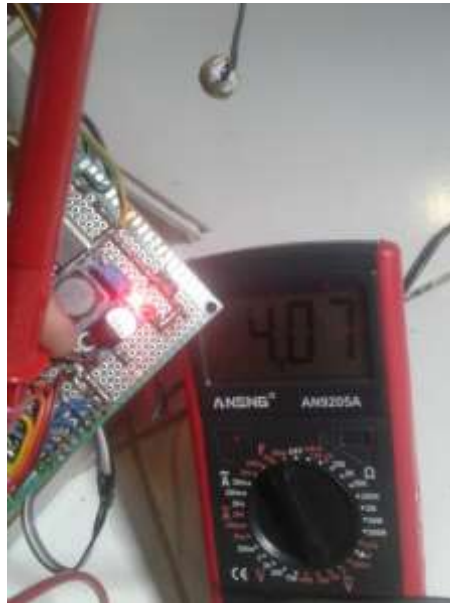
Gambar 4.8 hasil pengukuran tegangan saat sensor tidak mendeteksi halangan berupa tanah longsor
