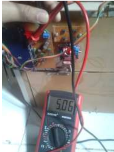
Gambar 4.6 Pengukuran Tegangan pada port I/O Arduino Mega2560
