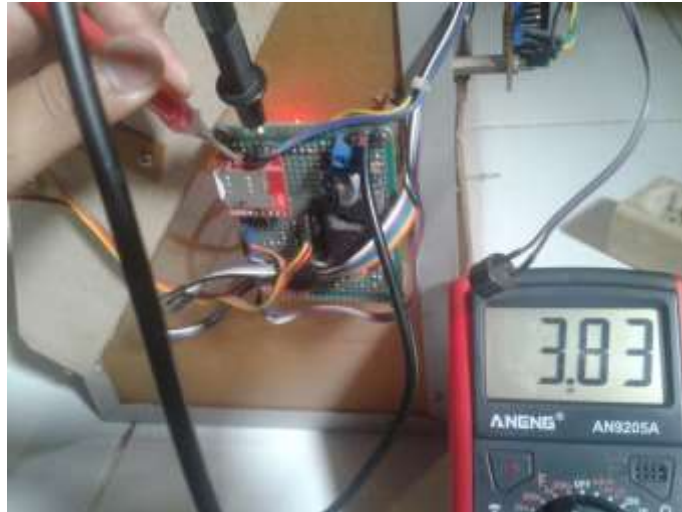
Gambar 4.16 Pengukuran tegangan GSM sim800
