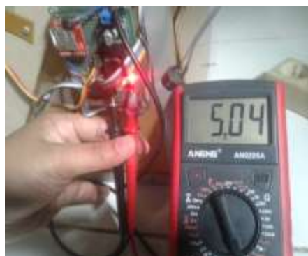
Gambar 4.4 Pengukuran dan pengujian tegangan pada TP3
