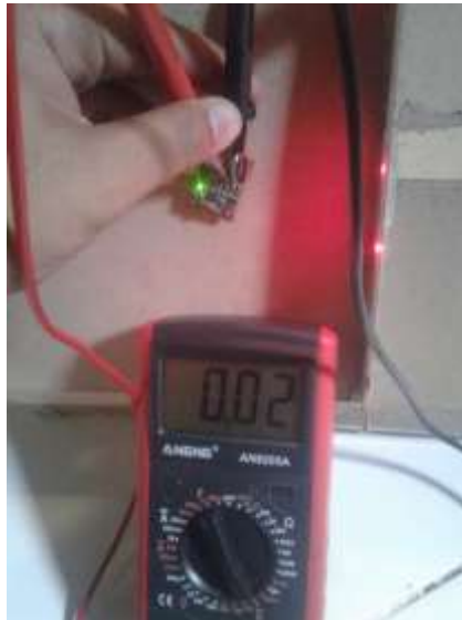
Gambar 4.12 Pengukuran tegangan sensor Accelerometer saat tidak mendapat Kemiringan
