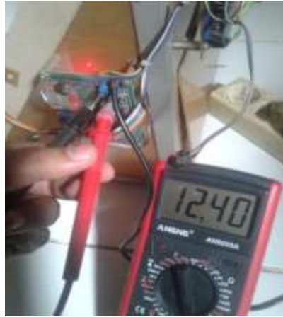
Gambar 4.3 Pengukuran catu daya dengan Multimeter
