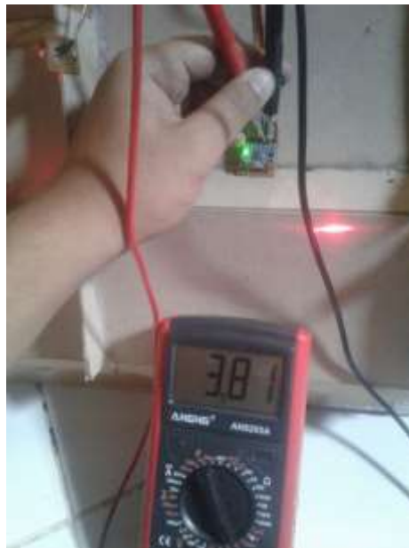
Gambar 4.11 Pengukuran tegangan sensor Accelerometer saat mendapat kemiringan
