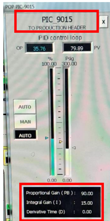
Gambar 1.3 Nilai Pengendali Proporsional Integral pada Tekanan discharge pompa
