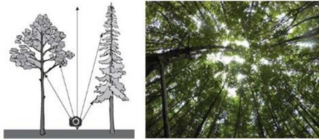
42 Gambar 2.7 Ilustrasi Metode Hemispherical Photography untuk Mengukur Tutupan Mangrove
