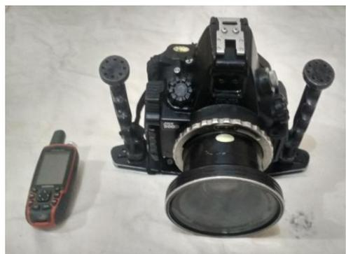
Gambar 2. Kamera Under water dan GPS
