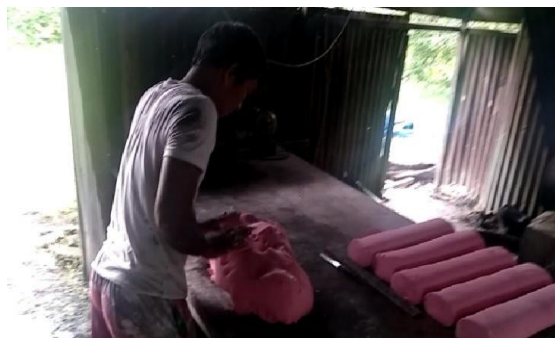
Gambar 2. 1 Cetakan tradisional lontongan kerupuk merah
