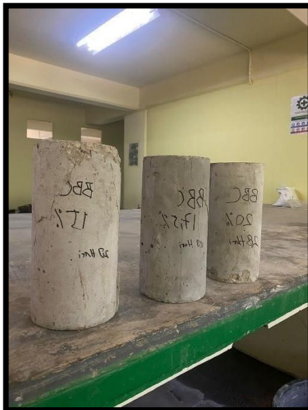
Gambar 4. 6 Benda Uji yang Telah Diuji
