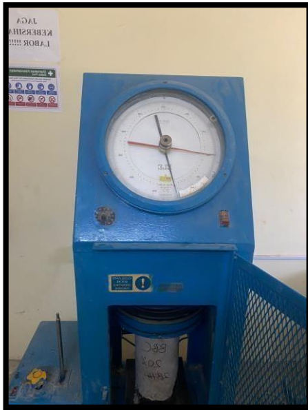
Gambar 4. 5 Pengujian Kuat Tekan Beton
