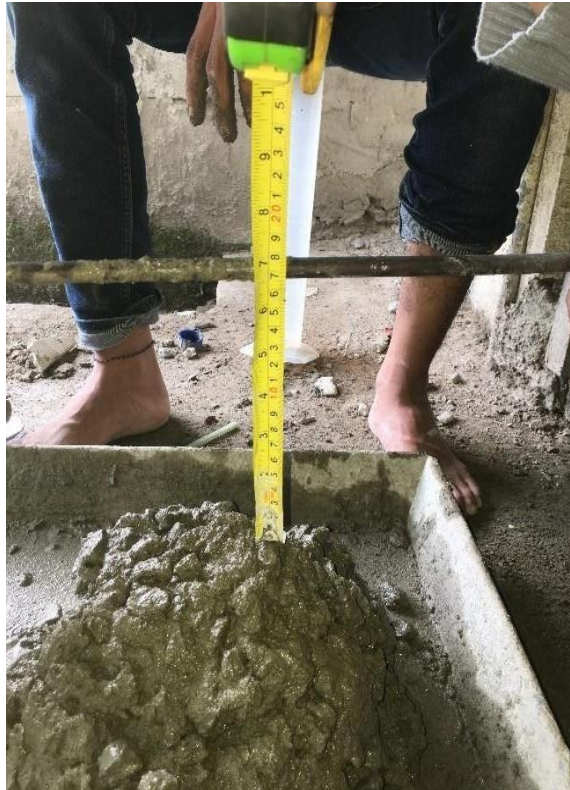
Pengujian Nilai Slump
