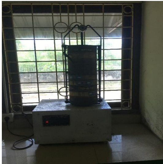
Pengujian Analisa Saringan abu batu
