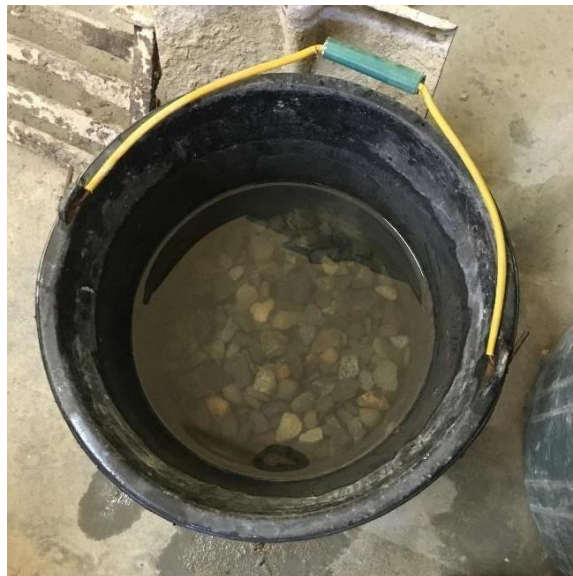
Perendaman Agregat Kasar Keadaan Jenuh Permukaan 24 Jam
