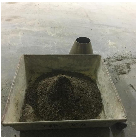
Agregat halus direndam selama 24 jam kemudian dikeringkan permukaan dan diangkat menggunakan kerucut abram
