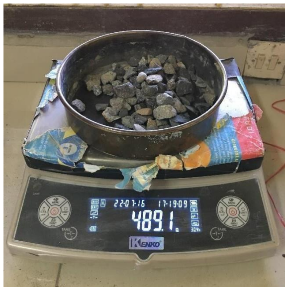
Penimbangan Berat Agregat Kasar Kering Oven
