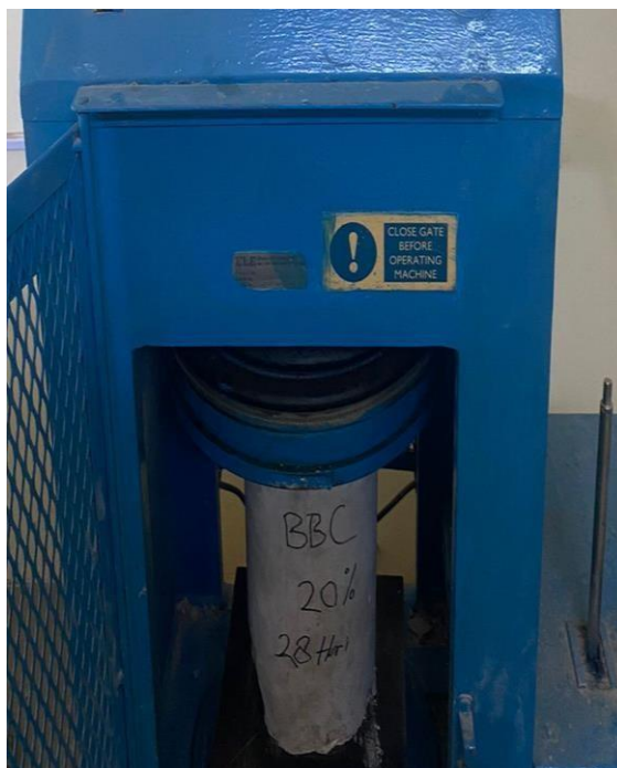
Pengujian Kuat Tekan Beton
