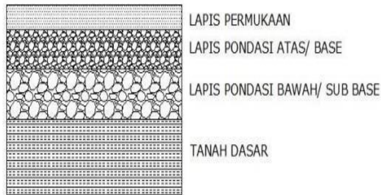
Gambar 2.1 Susunan lapis perkerasan lentur
