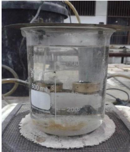
Gambar 3. 1 Uji Titik Lembek Aspal
