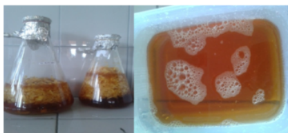
Gambar 1. Proses delignifikasi dan hasil cairan yang mengandung lignin.
