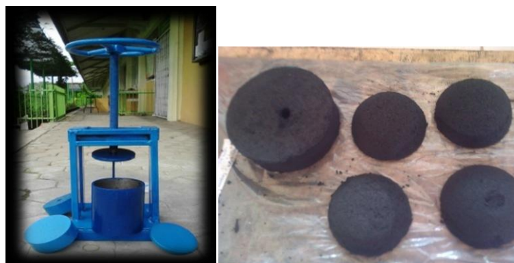
Gambar 1. Bentuk alat pencetak dan hasil biobriket bentuk silinder dan elipsoidal
