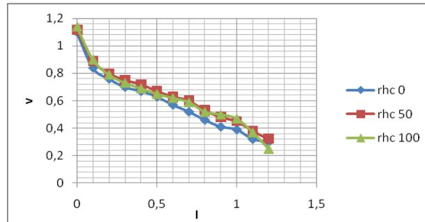
Gambar 5. Kurva polarisasi PEMFC dengan variasi RHc
