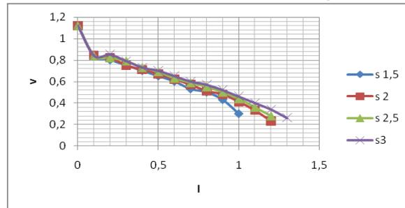
Gambar 6. Kurva polarisasi PEMFC dengan variasi rasio stoikiometri
