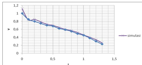
**Gambar 10.** Kurva polarisasi PEMFC dengan rasio stoikiometri 2 oleh Wei Yuan et al (2008)
