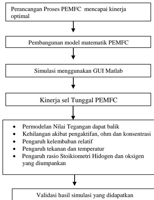
Gambar 2. Diagram Alir Metodologi Rancangan Proses Sel Tunggal Pada Sistem PEMFC
