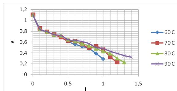
**Gambar 3.** Kurva polarisasi PEMFC dengan berbagai temperatur
