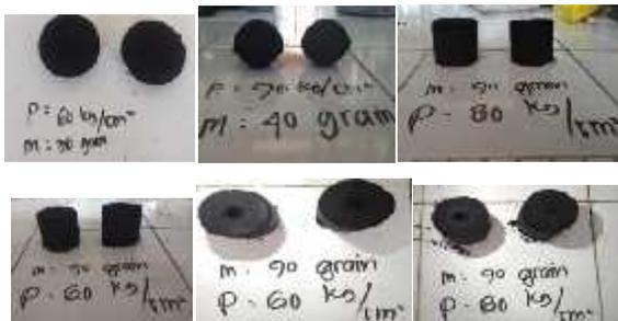
Gambar 9. Bentuk-bentuk model Biobriket dari alat pencetak hasil rancangan
