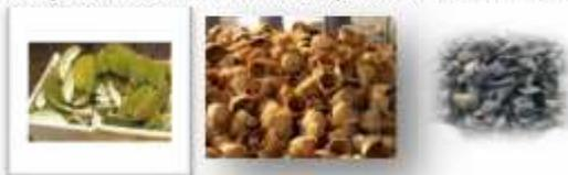
Gambar 2. Bahan baku biobriket kulit durian, cangkang sawit dan tempurung kelapa
