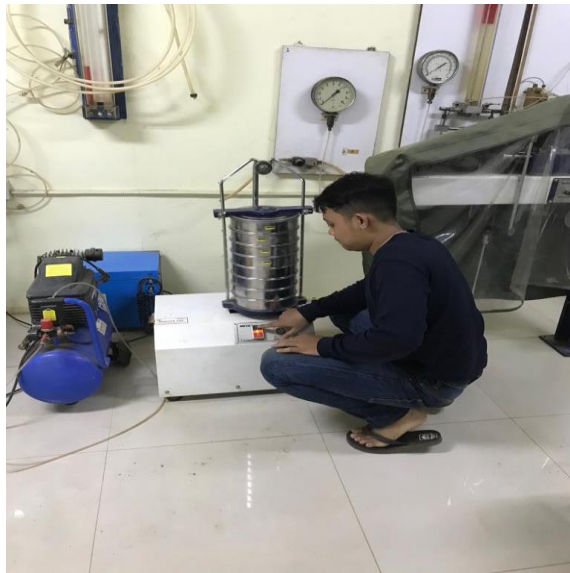
Pengujian Analisa Saringan
