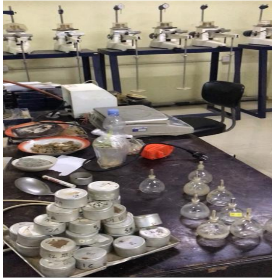
Pengujian Batas Cair
