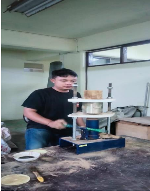
Mengeluarkan Sampel Compaction Dari Dalam Mold Dengan Menggunakan Dongkrak
