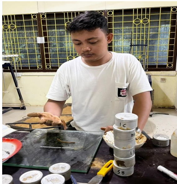
Pengujian Batas Cair
