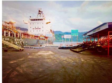
Gambar 1.1 Kapal bersandar di dermaga CPO dengan flexible hose terpasang pada loading point di sisi samping dermaga.
