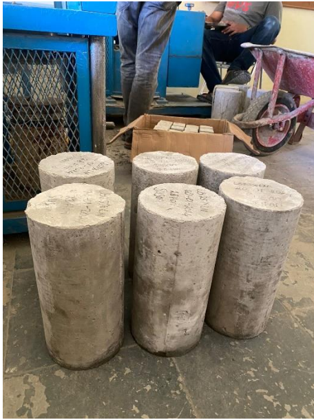
Beton Setelah Proses Curing
