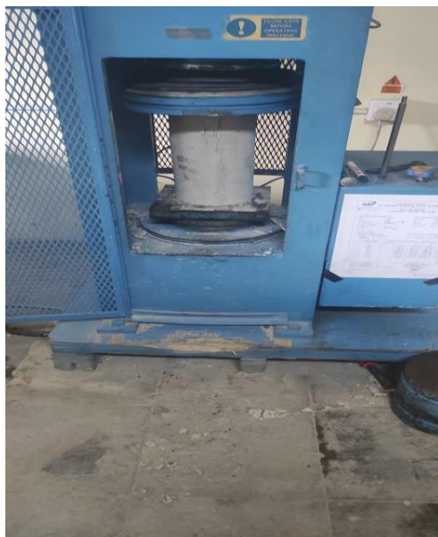
Pengujian Kuat Tekan Beton
