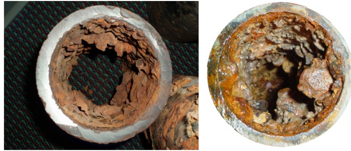
Gambar 5.2 Lapisan Kerak pada Pipa
