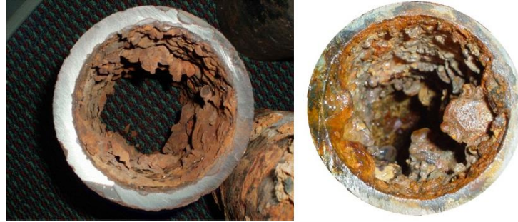
Gambar 5.2 Lapisan Kerak pada Pipa
