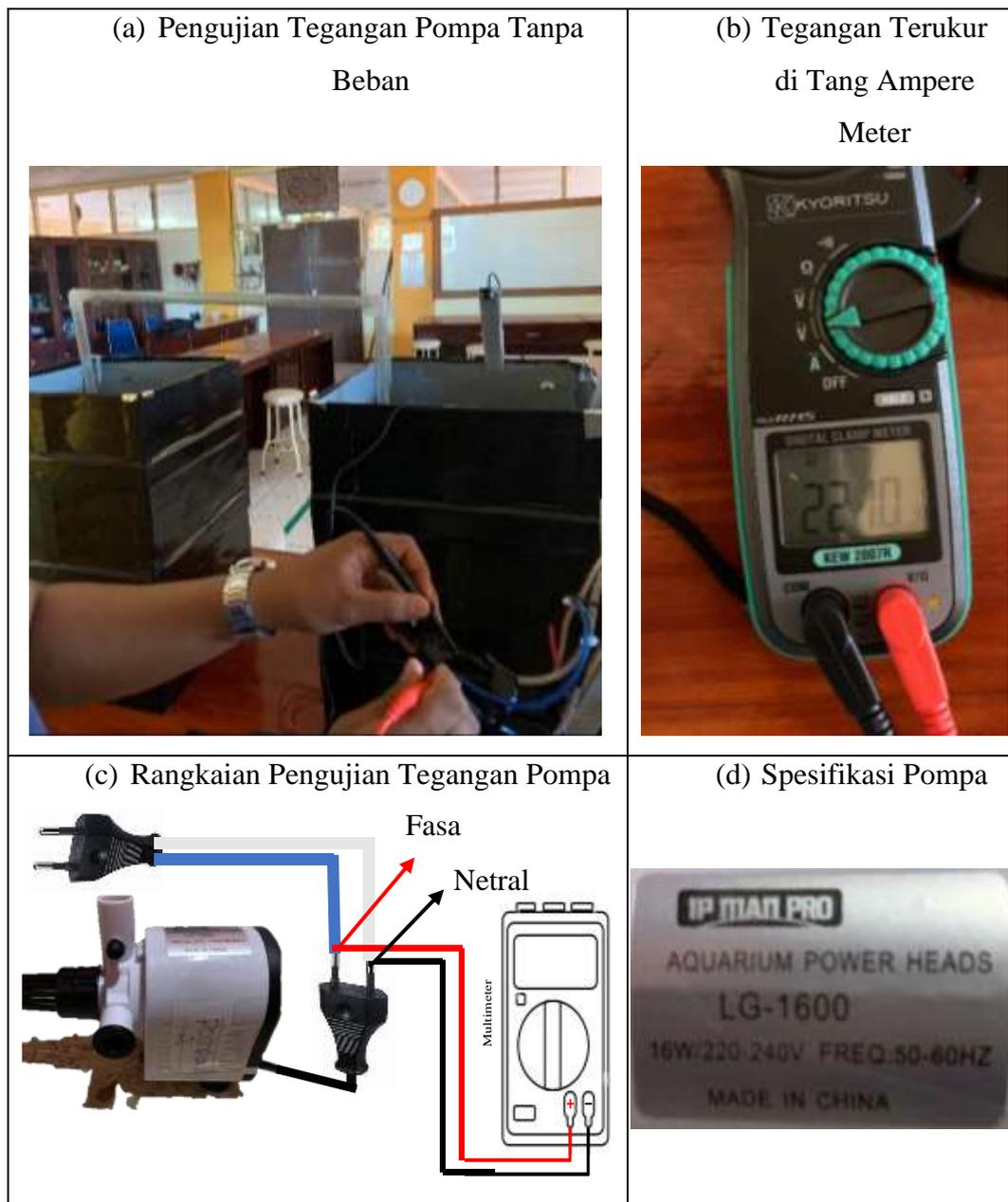
Gambar 4.6 Pengujian Tanpa Beban Pompa *Aquarium Power Head LG-1600*
