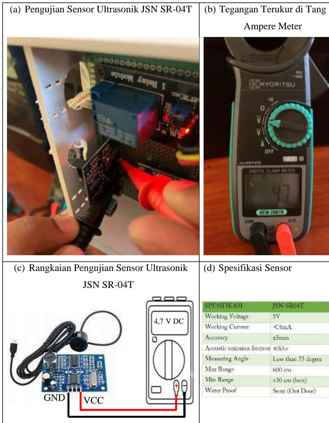
Gambar 4.10 Rangkaian Pengujian Tegangan Operasi Sensor Ultrasonik JSN-SR04T
