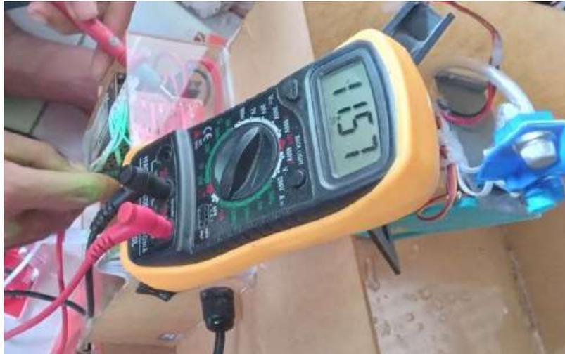
Gambar 4.7 Pengujian channel 2 pada kondisi *Normally Close* (NC)
