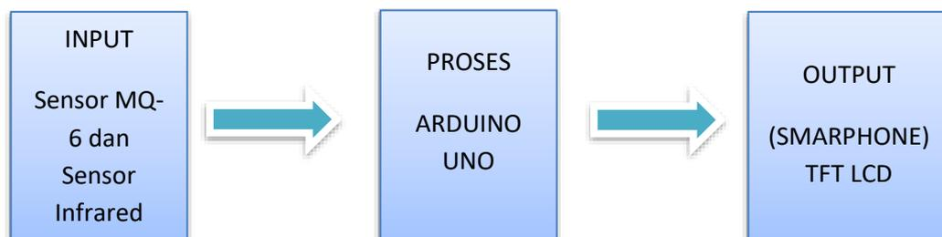
Gambar 3.2 blok diagram perancangan prototype pendeteksi kebakaran rumah dan pemadam otomatis berbasis internet of things.
