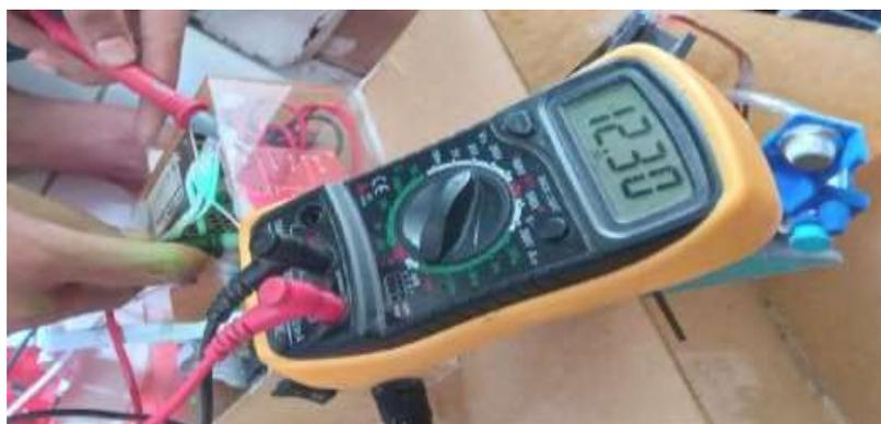
Gambar 4.6 Pengujian channel 1 pada kondisi *Normally Close* (NC)
