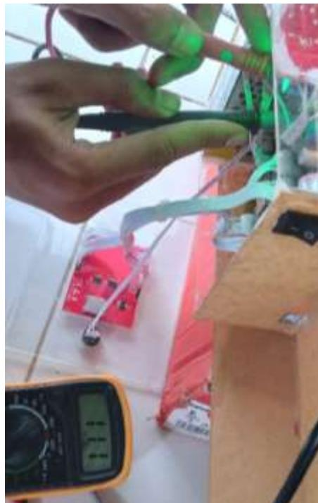
Gambar 4.1 Pengujian Tegangan 12V
