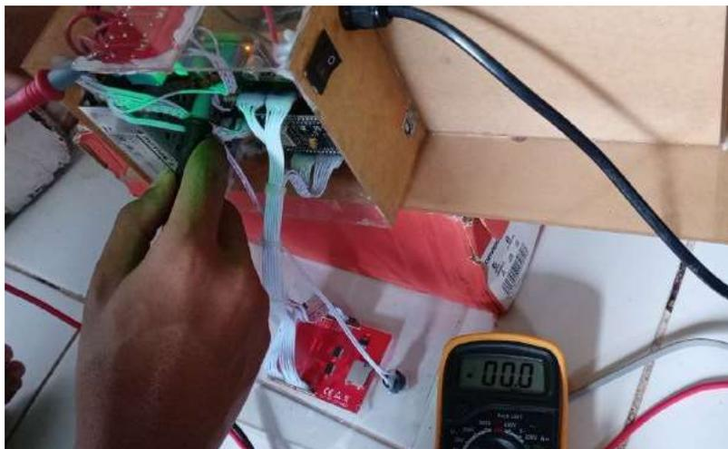
Gambar 4.8 Pengujian channel 2 pada kondisi *Normally Open* (NO)
