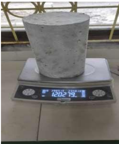
Beton setelah proses curing
