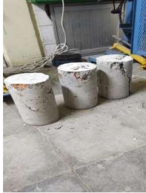
Kerusakan sampel setelah diuji
