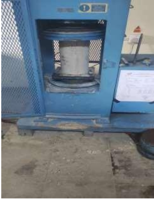
Pengujian kuat tekan beton
