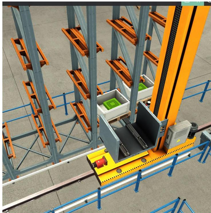
Gambar 4.9 Robot lift menyusun barang ke rak
