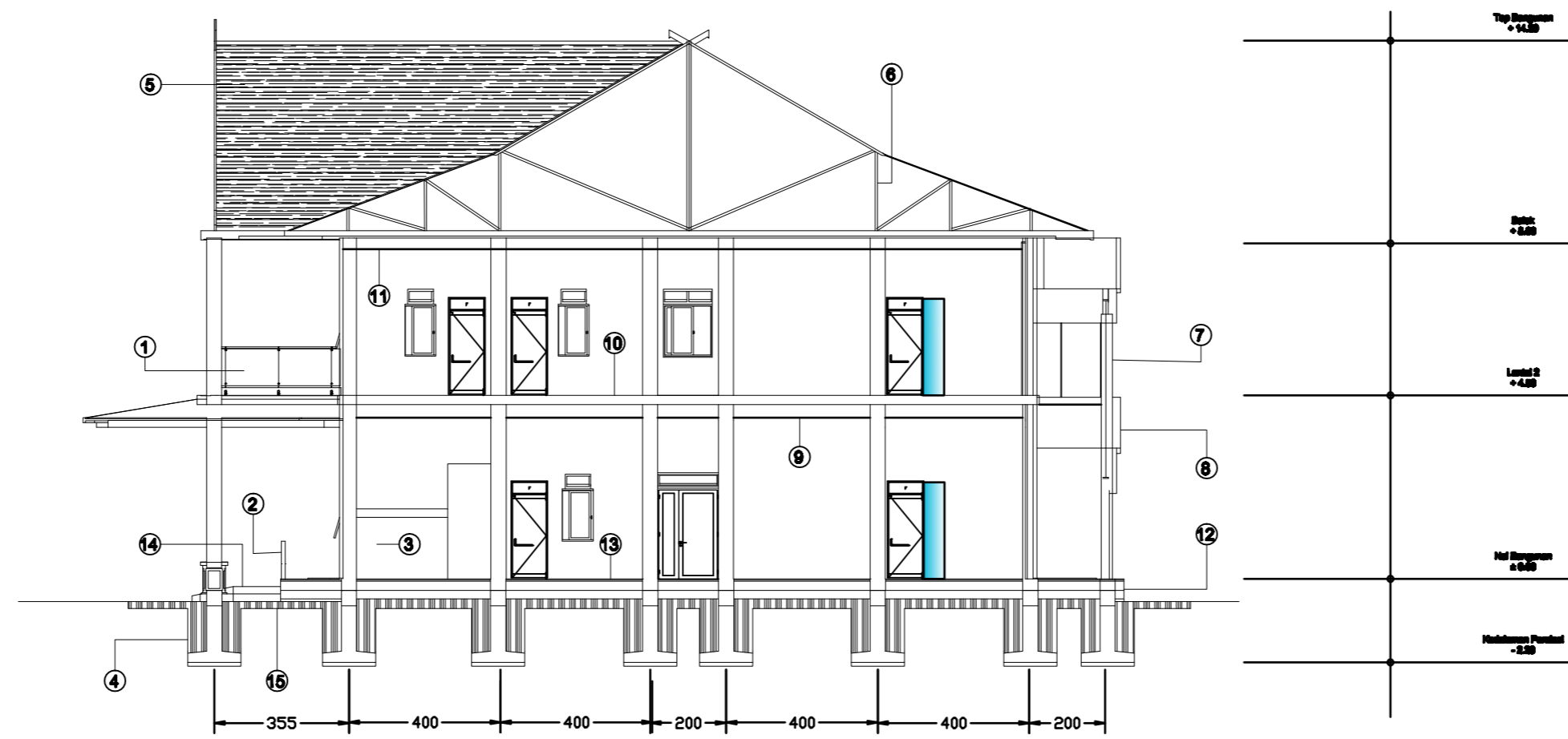
POTONGAN PRINSIP UNIT REHAB MEDIC DAN ISOLASI 1 : 100
