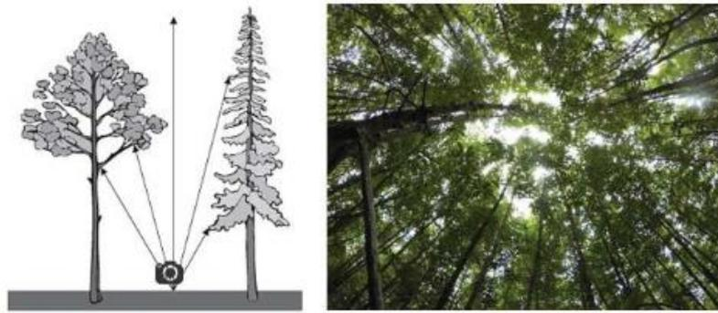
**Gambar 2.7** Ilustrasi Metode Hemispherical Photography untuk Mengukur Tutupan Mangrove
