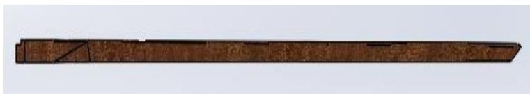
**Gambar 4.19** Bilah tipe *taperless* 3 dimensi tampak kanan
