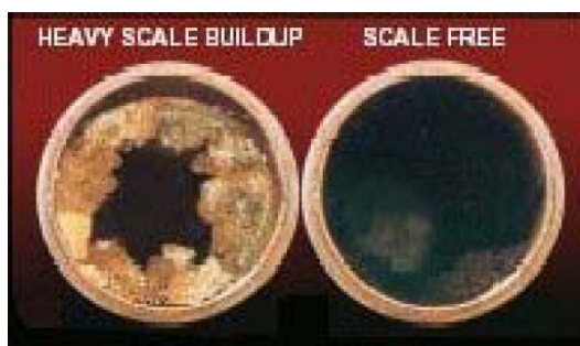
Gambar 5.2 Lapisan Kerak pada Pipa
