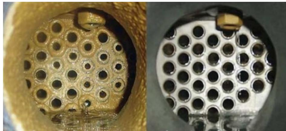
**Gambar 5.2 Lapisan Kerak pada Pipa**
