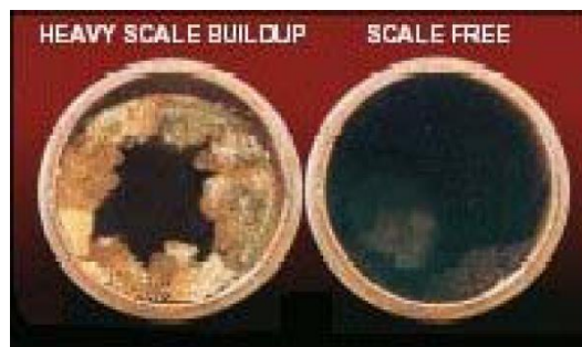
Gambar 5.2 Lapisan Kerak pada Pipa
