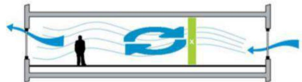
Gambar 6.4 Potongan penampang simulasi pergerakan angin didalam bangunan
