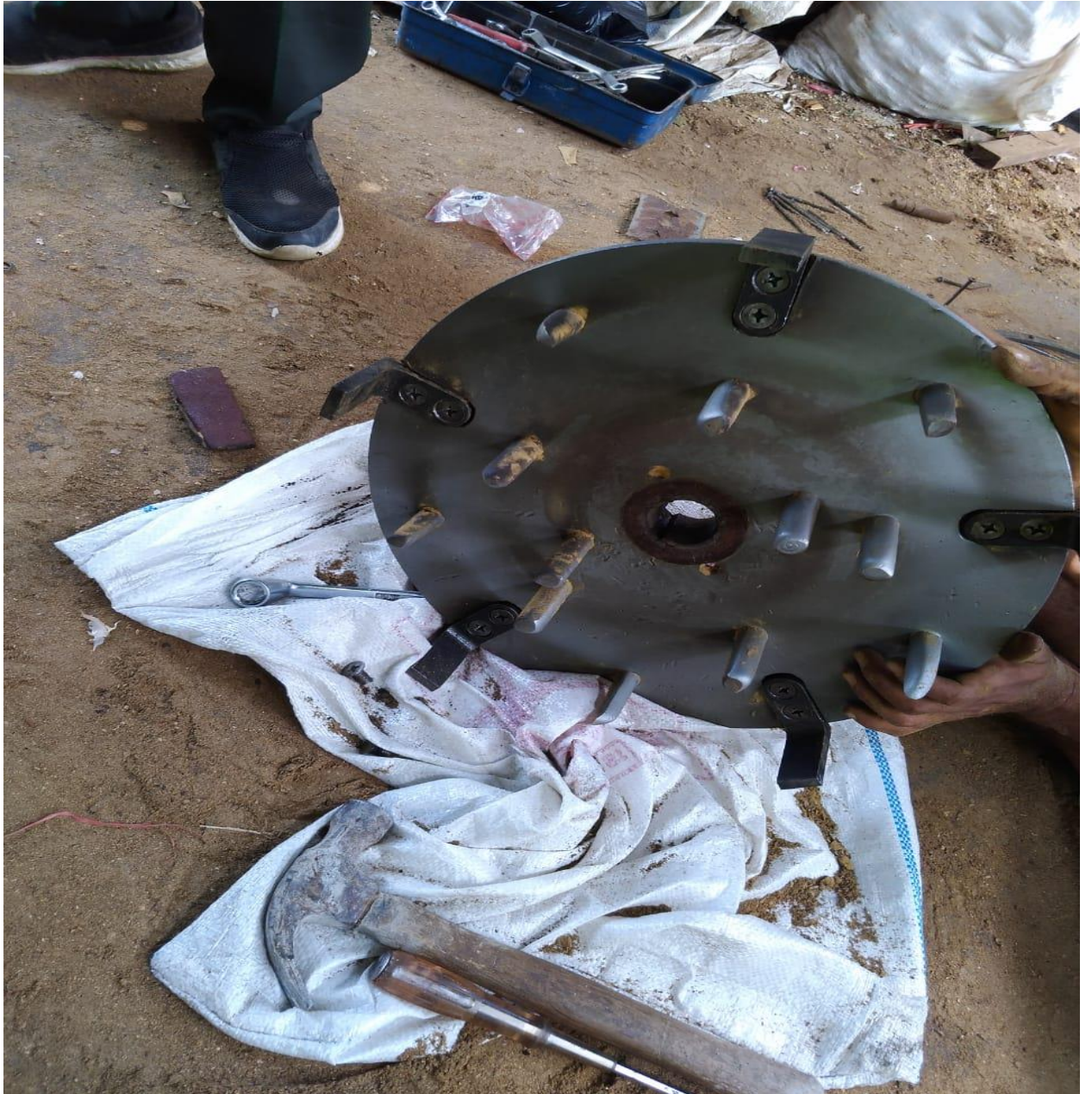
Gambar 5. Penggantian mata pisau berbentuk L mesin hammer mill
