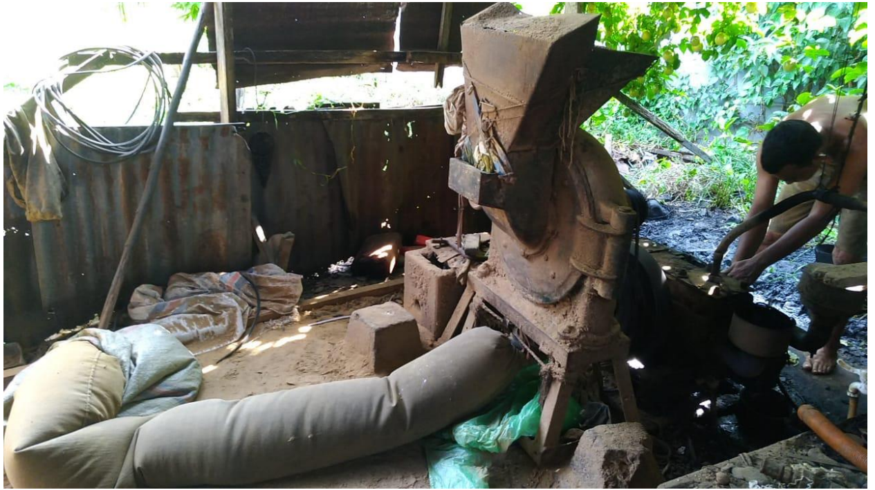
Gambar 4. Perbaikan mesin penggerak motor diesel 24 hp, penggantian alat injeksi bahan bakar dan penggantian slang bahan bakar
