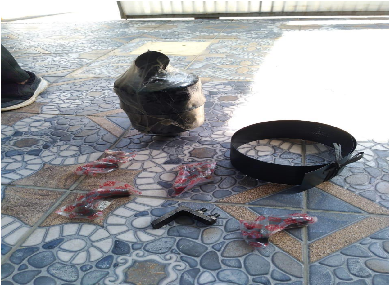
Gambar 1. Peralatan dan suku cadang pengganti, pisau hammer mill, Knalpot Mesin diesel, saringan mesin hammer mill.
