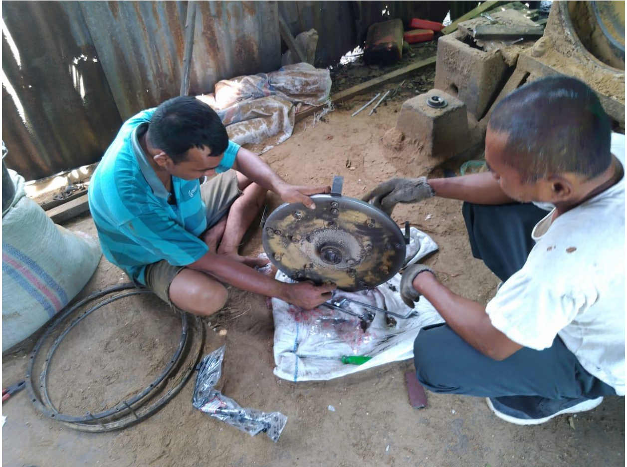
Gambar 3. Perbaikan, bagian mesin hammer mill yang berputar. Penggantian mata pisau dan untuk mengikat, setelah dibaut dilakukan pengelasan dengan las listrik
