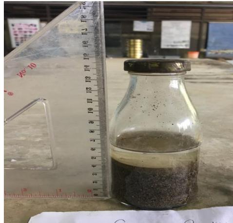
**Gambar 3.5 Pengujian Kadar Lumpur Agregat Halus Secara Lapangan**
