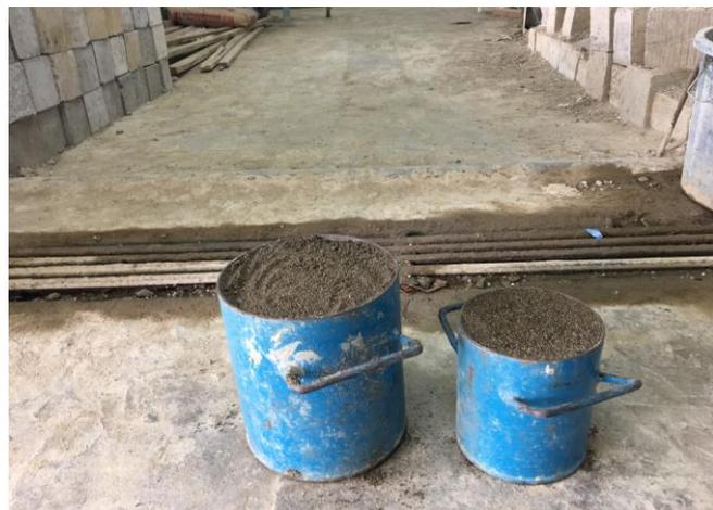
**Gambar 3.6 Penentuan Bobot Isi Agregat Halus**
