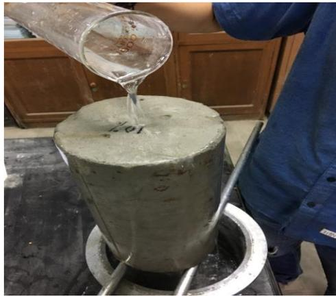
**Gambar 3.19 Permeabilitas Beton**
