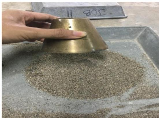
**Gambar 3.4 Pengujian Berat Jenis SSD Agregat Halus**
