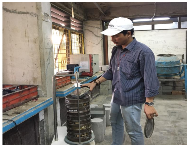
Lampiran.16 Pengujian analisa saringan agregad halus
