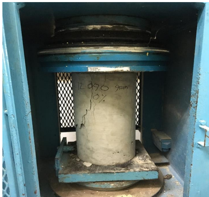
Lampiran.45 Proses beton saat setelah pengujian kuat tekan
