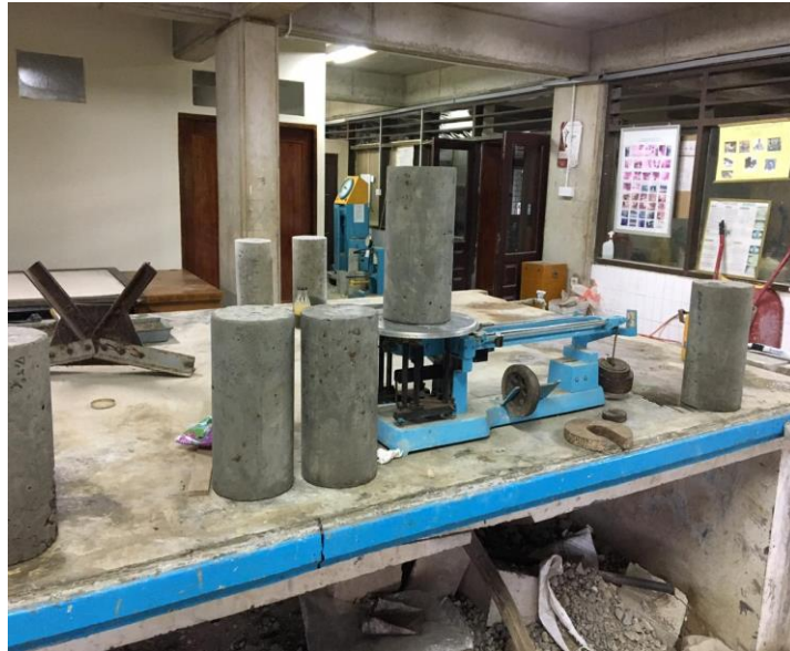
Lampiran.35 Penimbangan setelah pengujian permeability
