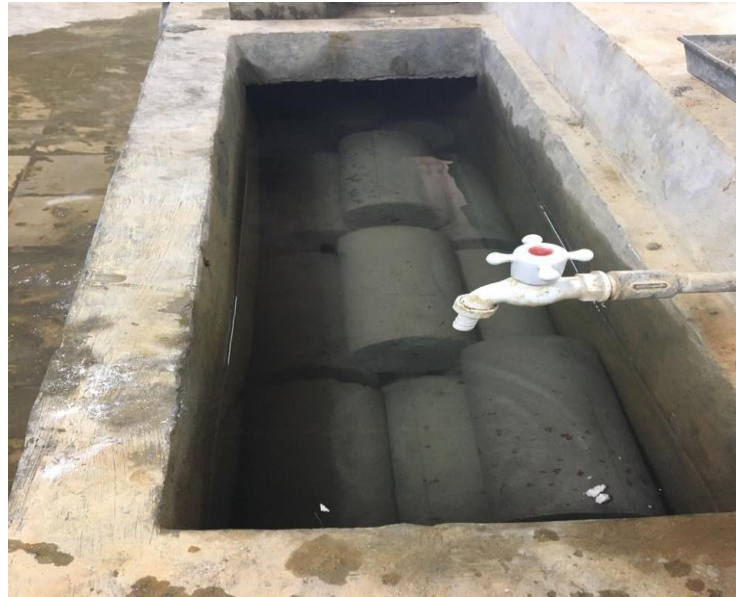
Lampiran.33 Proses curing pada beton
