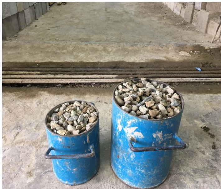
Lampiran.10 Pengujian bobot isi agregat kasar
