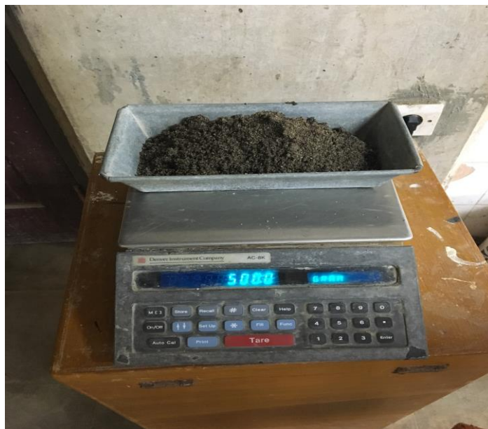
Lampiran.14 Penimbangan berat kadar air dan kadar lumpur Agregat halus
