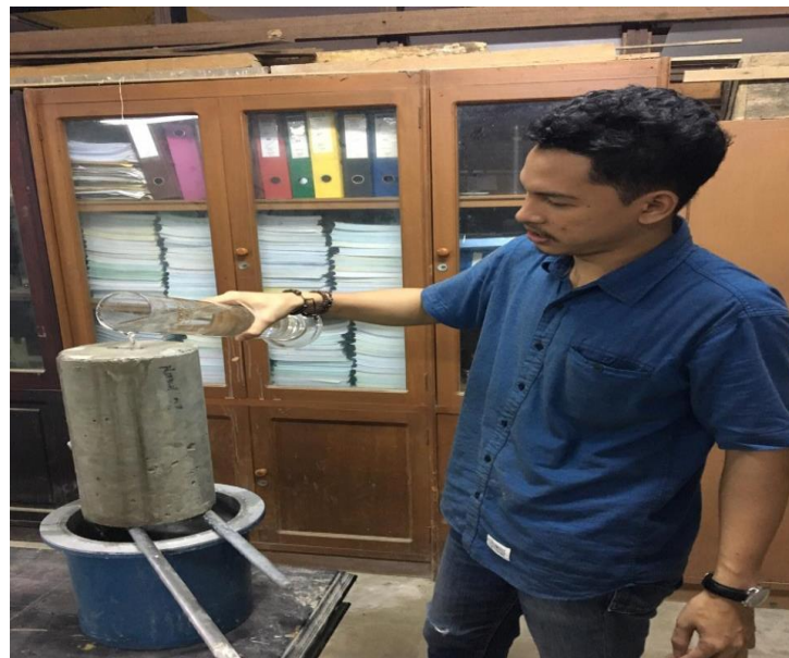
Lampiran.34 Proses pengujian permeability pada beton
