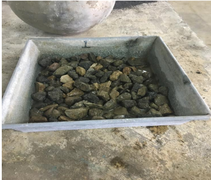
Lampiran.5 Pengujian berat jenis SSD agregat kasar
