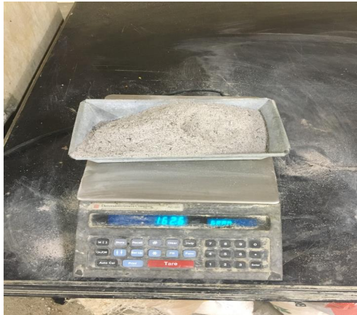
Lampiran.21 Proses penimbangan abu tempurung kelapa
