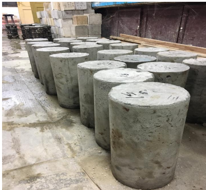
Lampiran.32 Proses pembukaan bekisting beton silinder
