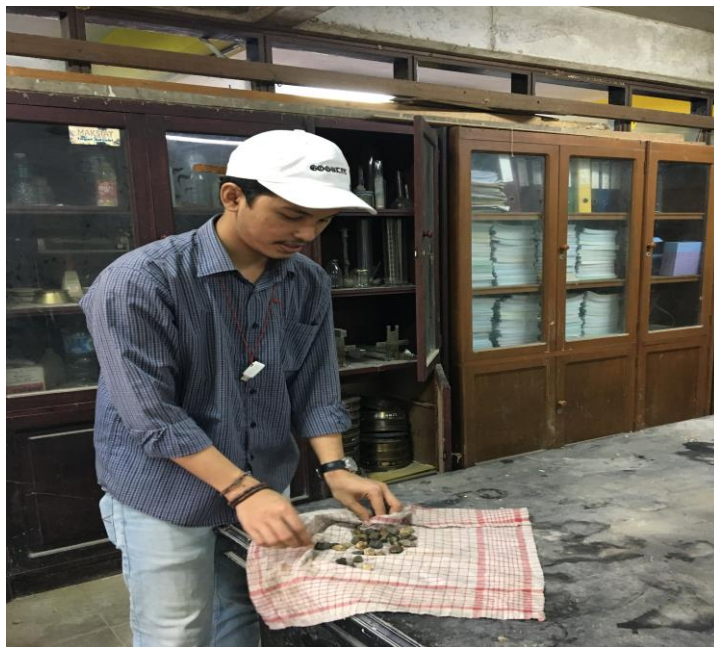
Lampiran.6 Proses pengeringan agregat kasar
