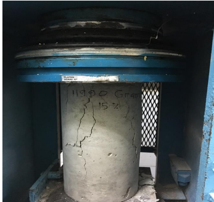
Lampiran.46 Proses beton saat setelah pengujian kuat tekan
