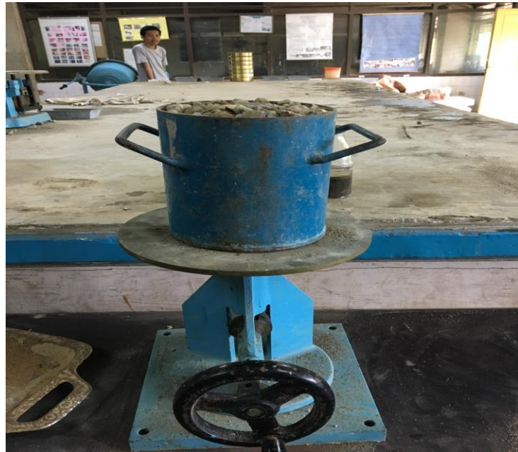
Lampiran.11 Proses pengujian bobot isi
