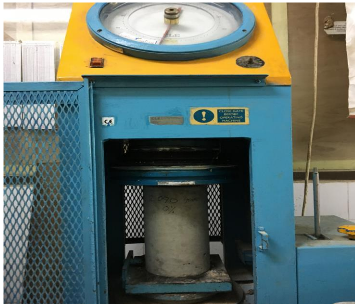
Lampiran.38 Proses pengujian kuat tekan
