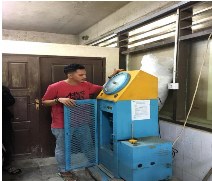
Lampiran.37 Prose pengujian kuat tekan beton
