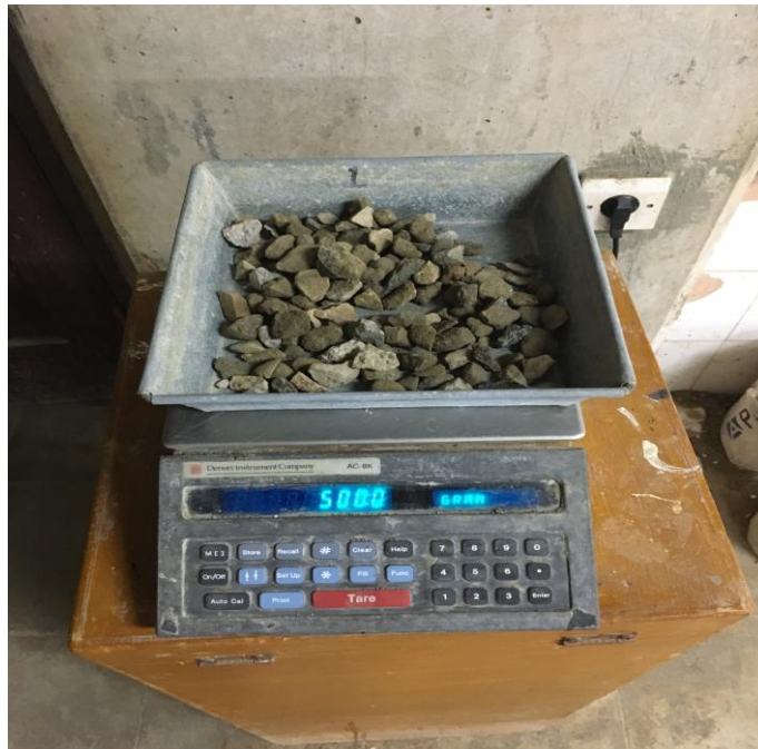
Lampiran.13 Penimbangan berat kadar air dan kadar lumpur Agregat kasar
