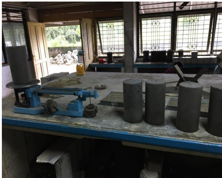
Lampiran.36 Proses penimbangan beton sebelum di uji kuat tekan
