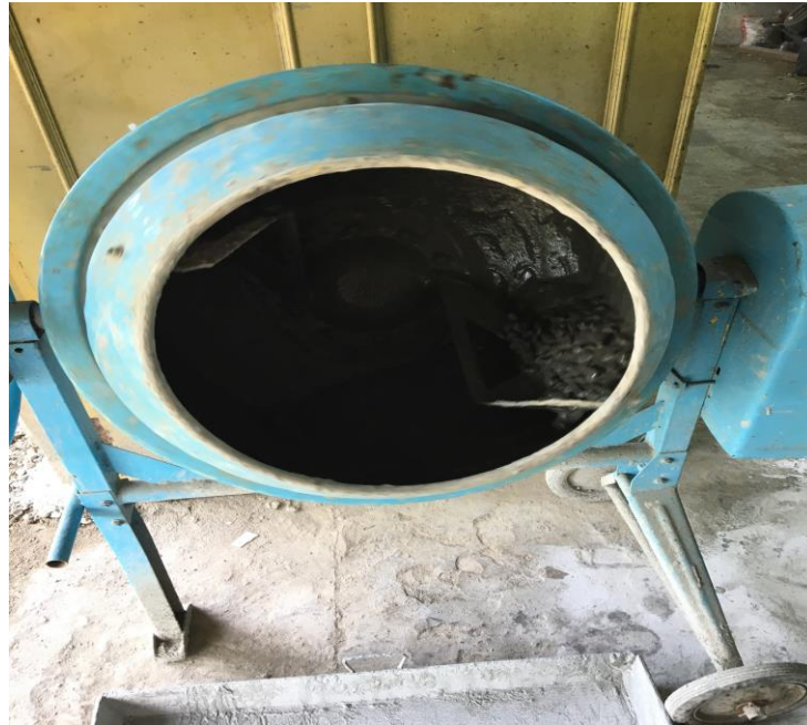
Lampiran.23 Proses pengadukan beton dalam molen
