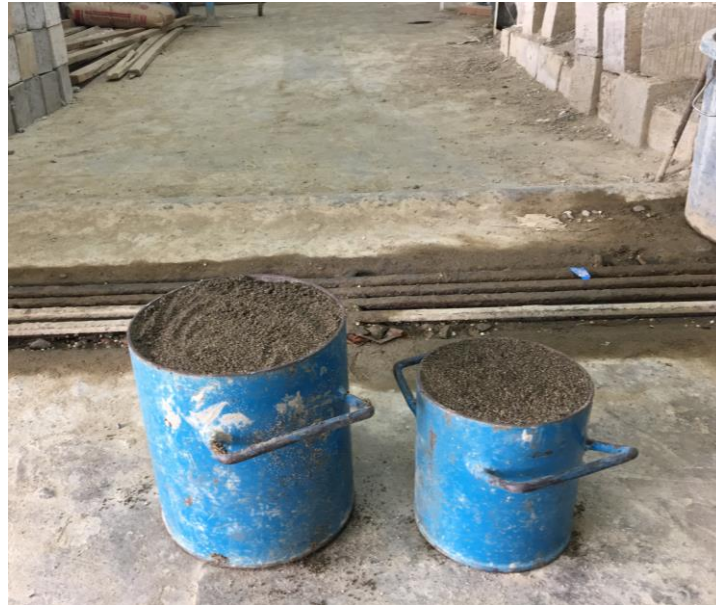
Lampiran.7 Pengujian bobot isi agregat halus
