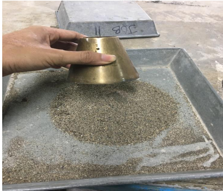
Lampiran.3 Pengujian agregat halus dengan kerucut abram
