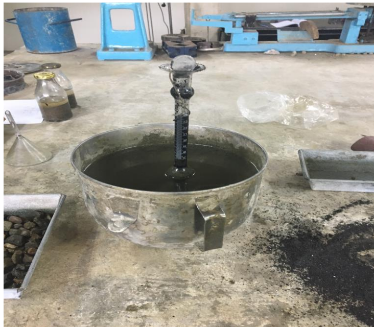
Lampiran.12 Pengujian berat jenis abu tempurung
