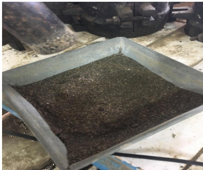
Lampiran.2 Proses pengujian berat jenis SSD agregat halus
