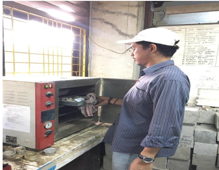
Lampiran.15 Proses pengovenan analisa saringan agregad halus dan kasar
