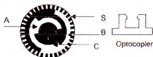
Gambar 9. Piringan enkoder dan optocoupler [5]
