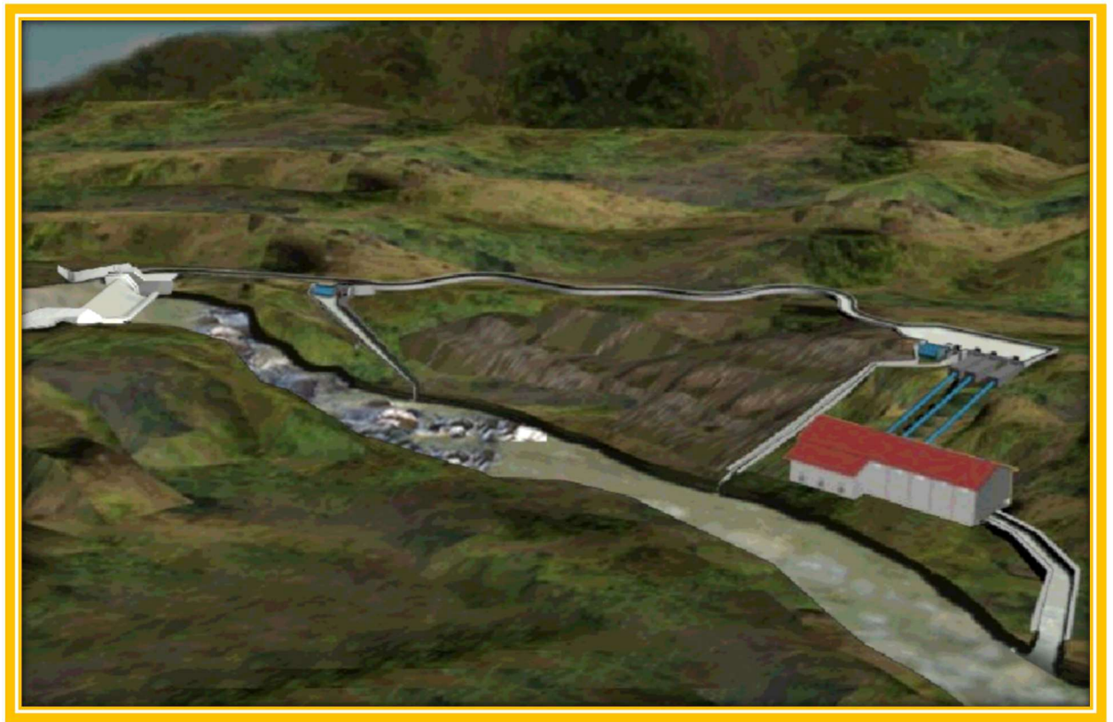
Gambar 5.1. Sistem PLTMH Secara Visual
