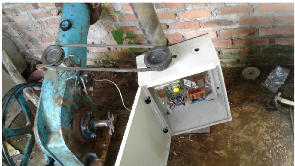
**Gambar 5.15. Rangkaian Driver dan Motor Penggerak GLC**
