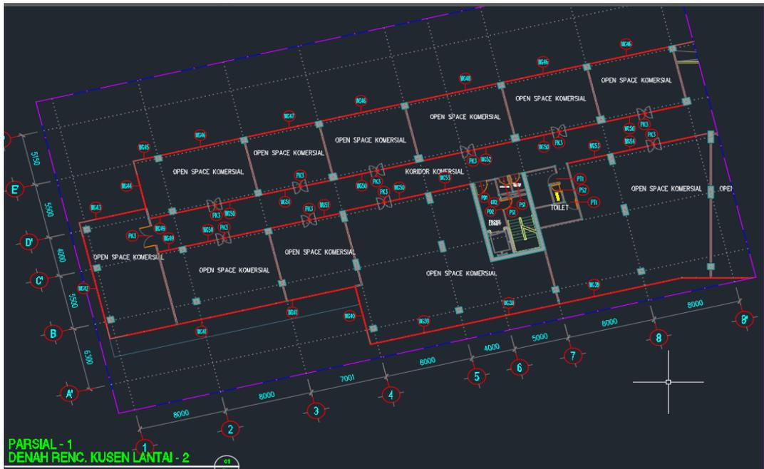
**Gambar 3.5 Denah Pekerjaan kusen pintu dan jendela**
