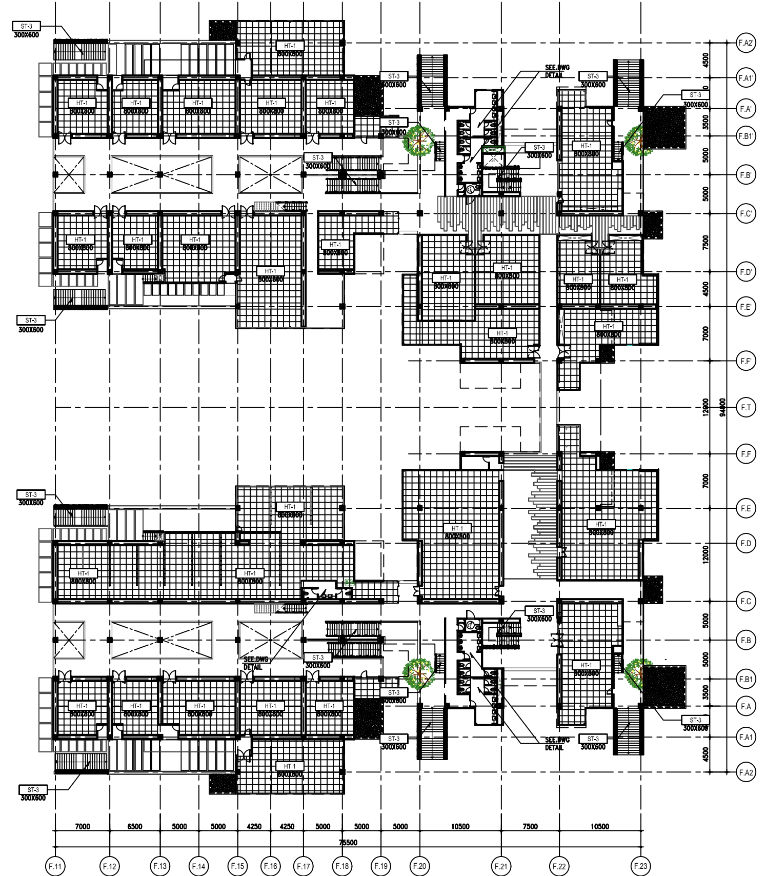
DENAH POLA LANTAI LT 2 SKALA 1 : 250
