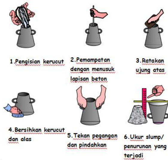
Gambar 1.8 Pengujian Slump
