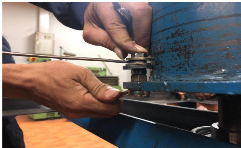
Gambar Proses pemasangan ujung kawat di Drum Penggulung
