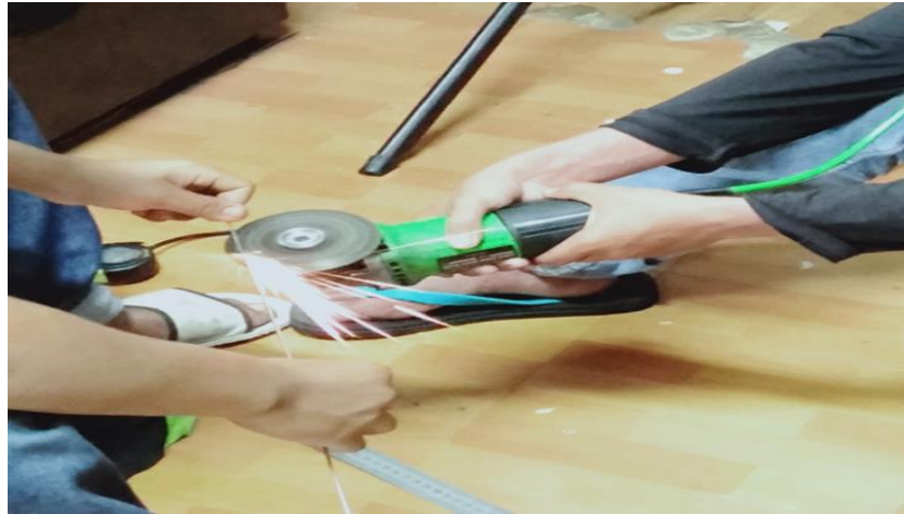
Gambar Proses Pengurangan diameter ujung kawat untuk di masukkan ke Dies menggunakan Gerinda Tangan
